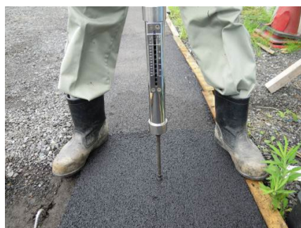
写真-3 プロクターニードル貫入試験状況
