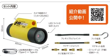
: 720p HD画質 視野角90° : 60~100分(LED点灯状態による) 時 間 :約100分 通 規 : WiFi 2.4GHz帯 IEEE802.11b/g/n 通 距 : 最長12m(遮蔽物がなく電波状況が良好な場合) 電 池 : リチウムポリマー電池 3.7V 500mAh : 充放電 約500回 電 池 寿 命 使用温度範囲 : 0~35℃ (保管温度: -20~45℃) 防 7k 規 格 : IP64(キャップが締まった状態) 水中通信は不可 : 静止画・動画の保存と再生、ライト点灯の操作が カメラ涌信アプリ 可能(ダウンロード無料) : iPhone又はiPad、 扙 Androidスマートフォン・タブレット等 : i OS 、Android OS (当社HPにてアップデート情報をご確認ください。) 本 体 サ : 22×32×82mm 体 質 量:35g
